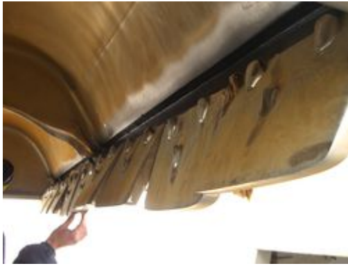
Vista de dientes desde el interior del cabezal.
